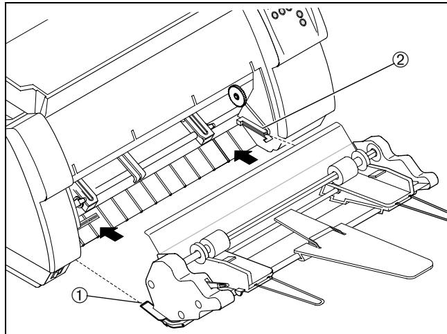
Procedere con l'installazione in modo che la rotella sulla guida d'inserimento si trovi sul lato destro.
