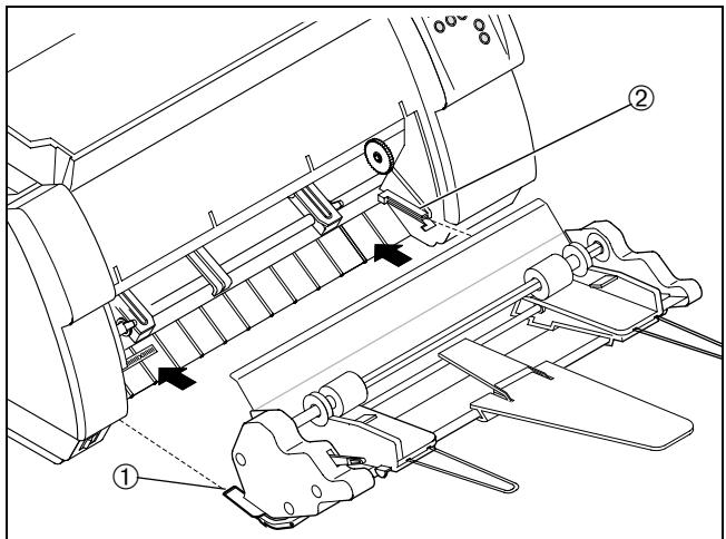
La instalación debe efectuarse de manera que la rueda dentada del alimentador de hojas sueltas se encuentre en el lado derecho.
