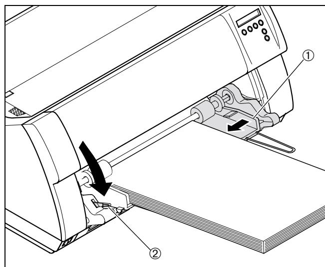
Ajuste la guía de papel derecha ① a la anchura del papel y alinee el soporte de papel del alimentador de hojas sueltas con el centro de la pila de papel. Empuje la palanca de fijación ② hacia abajo.
