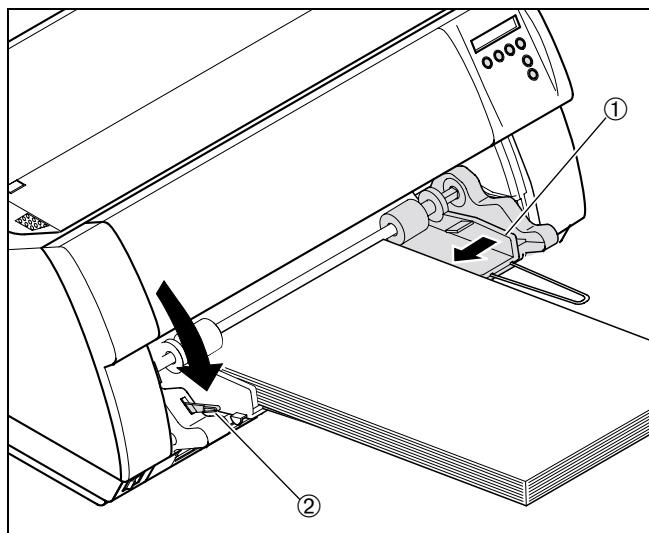
Die rechte Papierführung ① entsprechend der Papierbreite einstellen und die Papierstütze der Einzelblattzuführung mittig zum Papierstapel ausrichten. Den Arretierhebel ② nach unten drücken.
