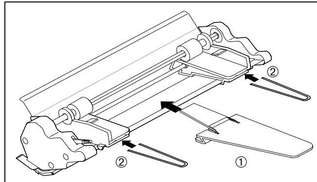
Fixez le support de papier ① sur l'appui. Introduisez les deux étriers des guides-papier ②dans les ouvertures des guides-papier prévues à cet effet.
