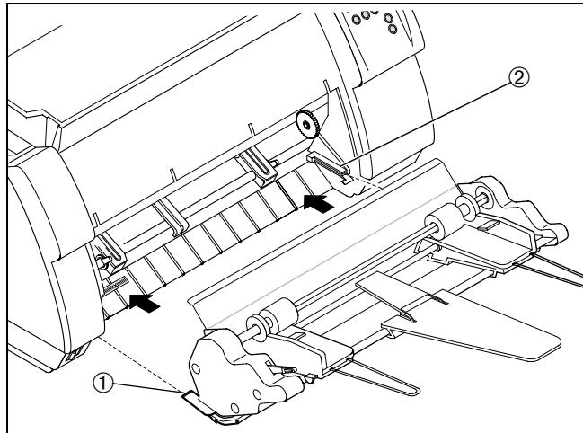
Der Einbau muß so erfolgen, daß sich das Zahnrad an der Einzelblattzuführung auf der rechten Seite befindet.
