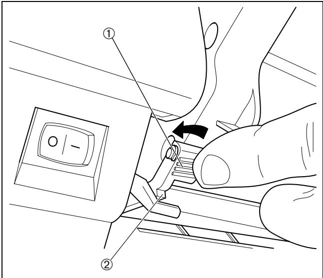
Déposer le capot inférieur.
