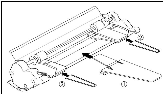
Die Papierstütze ① auf die Halterung stecken. Die beiden Bügel ② in die dafür vorgesehene Öffnung der linken und rechten Papierführung stecken.
