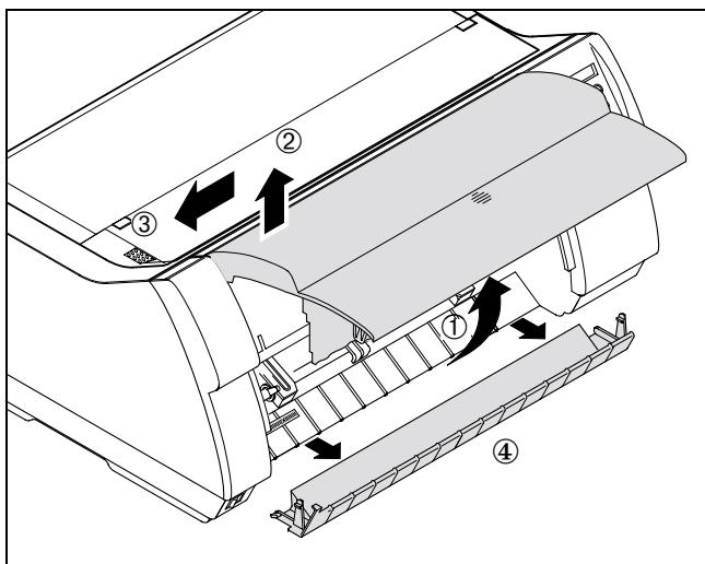
Die vordere Abdeckung abnehmen. Dazu die Abdeckung um etwa 90 Grad nach oben schwenken ①, links hochheben ② und dann links aus der Lagerung entnehmen ③. Die mit der Einzelblattzuführung mitgelieferte vordere Abdeckung in umgekehrter Reihenfolge einsetzen.
