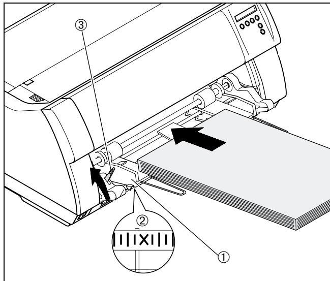
Die linke Papierführung ① an der Markierung auf der unteren Abdeckung ② ausrichten.
