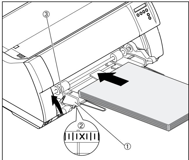
Aligner le guide-papier gauche ① au repérage sur le capot inférieur ②.
