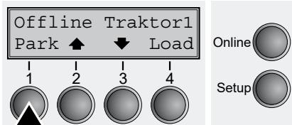
Sicherstellen, daß der Drucker Offline ist, gegebenenfalls die Taste **Online** drücken. Die Taste **Park** (1) drücken. Befindet sich Endlospapier im Drucker, wird es in Abreißposition transportiert.
